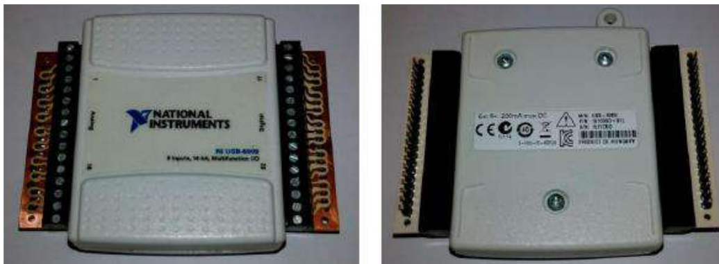
Figura 8.- Instalación de tarjetas de montaje en la tarjeta de adquisición de datos NI USB-6009.
