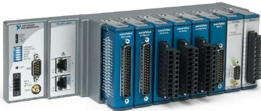
Figura 1.- Controlador embebido cRIO-9074 de National Instruments, imagen de https://www.ni.com/es-mx/support/model.crio-9074.html
