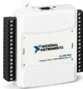
Figura 1.- Tarjeta de adquisición de datos NI USB-6009 de National Instruments, imagen de https://www.ni.com/es-mx/support/model.usb-6009.html
