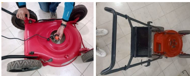
Figura 4. Sensor ultrasónico en podadora.
