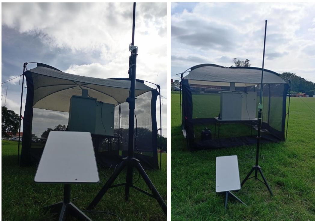
Figura 5. Alarma temprana infraestructura desplegada en campo. Fuente: Elaboración propia.
