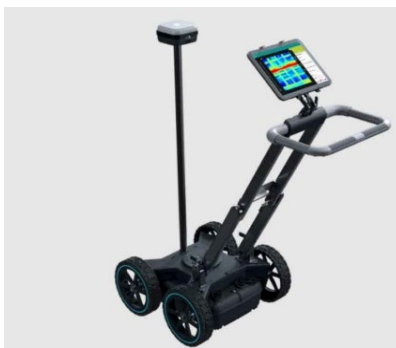
Figura 1. Radar de penetración terrestre. Fuente: Tomada de Internet (2024).
