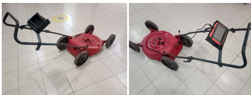
Figura 7. Podadora adaptada para portar sensor y Tablet.
