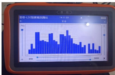
Figura 6. Señales indicadoras de agua.
