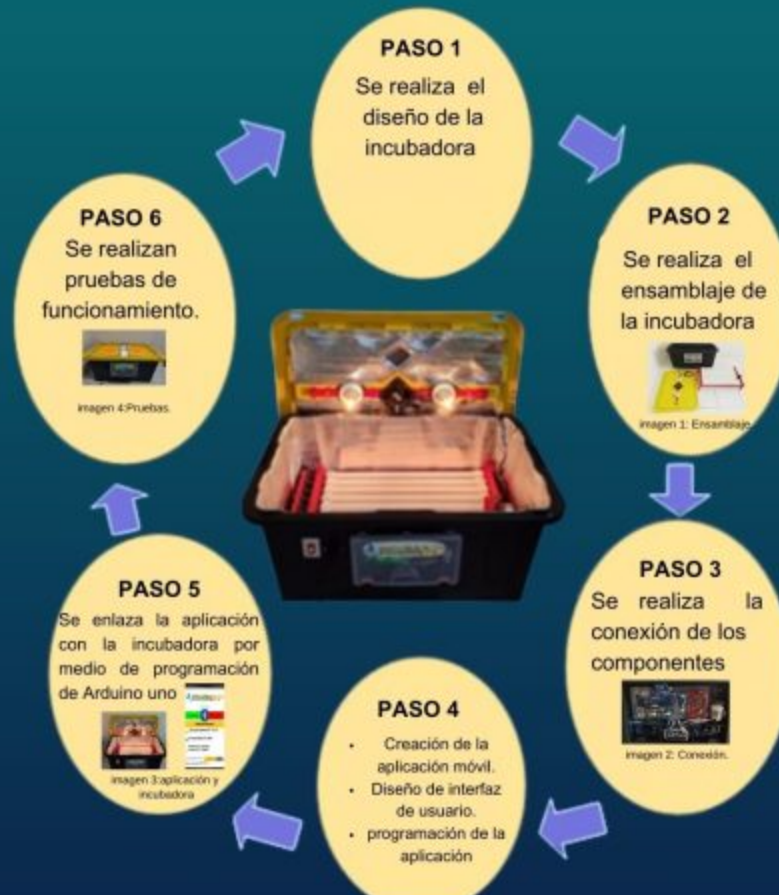
Imagen 1: Diagrama de creación de la incubadora
