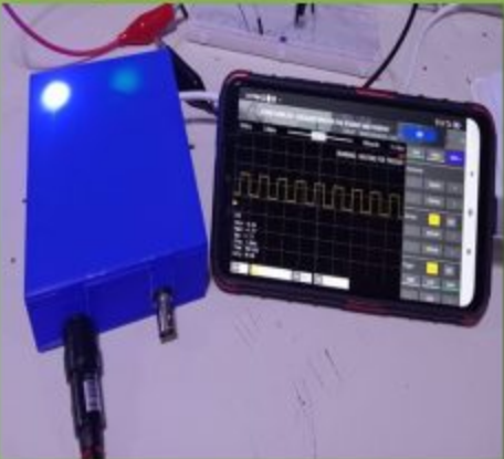
Figura 3. Mini Osciloscopio en su estuche conectado a celular
