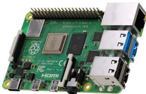
Figura 1.- Raspberry Pi Modelo B V1.1.
