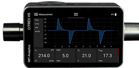
Figura 2. Analizador de flujo de gases CITREX H5 de IMT.Analytics.
