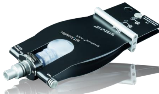
Figura 3. Pulmón artificial de prueba SmartLung Adult de IMT.Analytics, con capacidad total de 1 litro.
