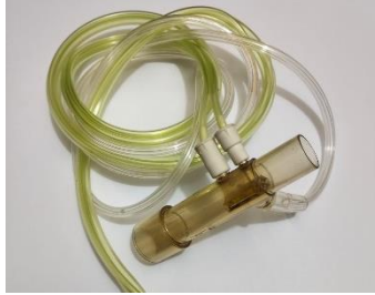
Figura 7.- Elemento primario de medición D-lite.
