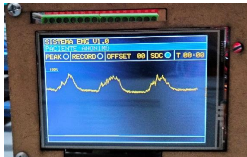
Figura 7.- Gráfica de muestro de datos EMG en entrada analógica cada 10 ms en pantalla LCD del prototipo, fuente propia.
