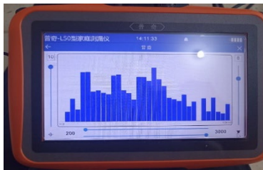
Figura 6. Señales indicadoras de agua.
