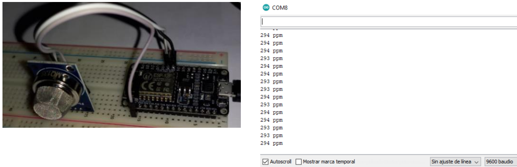
Figura 3. Lectura de ppm del MQ-135
