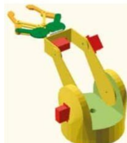
Imagen 5.- Brazo robótico de 3 grados (Cárdenas, 2012).
