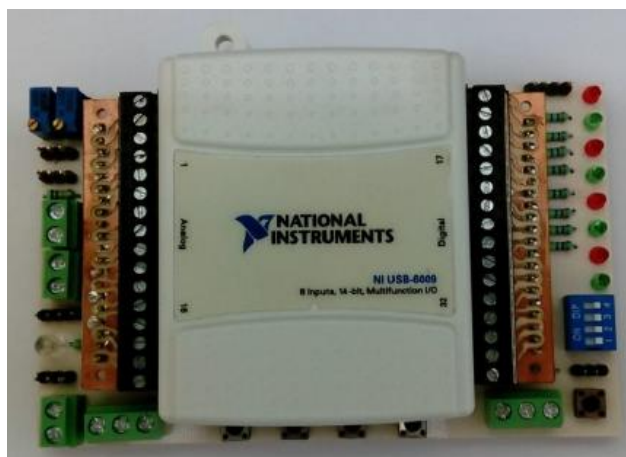
Figura 9.- Tarjeta de adquisición de datos NI USB-6009 instalada en la tarjeta de periféricos.
