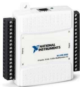
Figura 1.- Tarjeta de adquisición de datos NI USB-6009 de National Instruments, imagen de https://www.ni.com/es-mx/support/model.usb-6009.html
