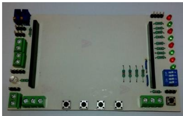
Figura 7.- Montaje de componentes en la tarjeta de periféricos.
