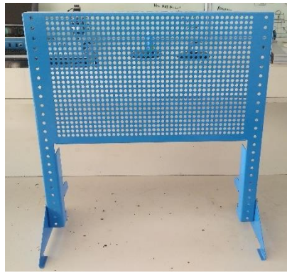
Figura 3.- Soporte metálico empleado para el montaje del banco de pruebas.
